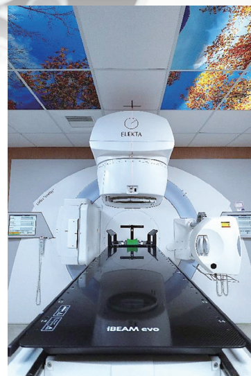
▲ 圖為本院放射腫瘤科治療室內的 ELEKTA Synergy 直線加速器，其兩側即是 IGRT (Image-Guided Radiotherapy, 影像導引放射治療系統)
